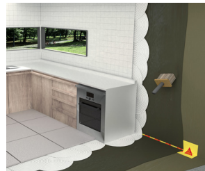
ทากันรั่วซึมก่อนการปูกระเบื้อง ห้องครัว
