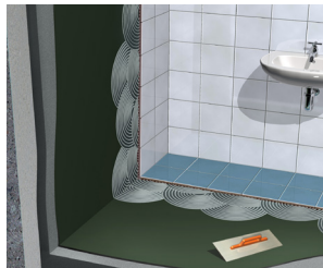
ฉาบกันรั่วซึมก่อนการปูกระเบื้อง ห้องน้ำ
